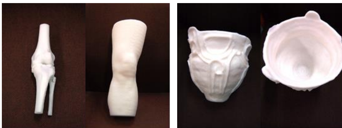
図 2.2.3 3D プリンタ装置によるラピッドプロトタイピング（膝モデル，土器モデル）
