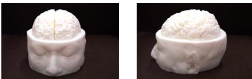
図 2.2.2 3D プリンタ装置によるラピッドプロトタイピング（頭部モデル）
