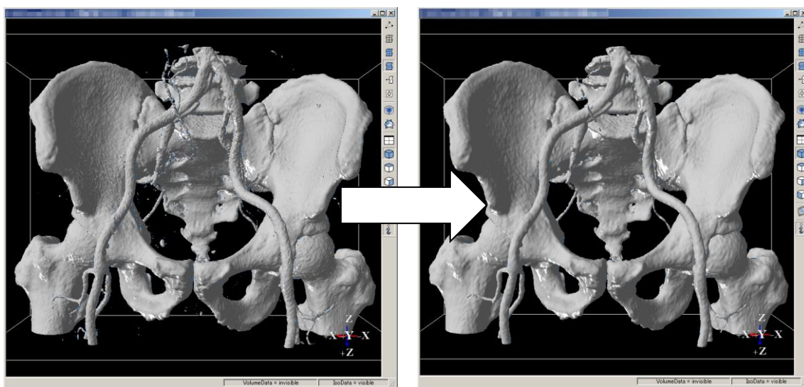
図 4.12.6 “3D Printer Mode” OFF/ON での等値面の変化
