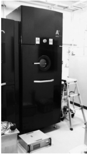
図5 EBW装置 (Arcam社、東北大学金属材料研究所)
