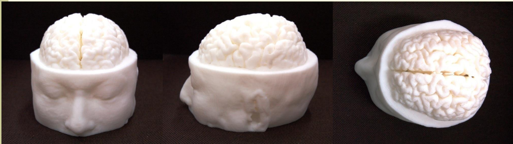
上図 熱溶解積層方式 による出力例 - ABS 樹脂による造形例
