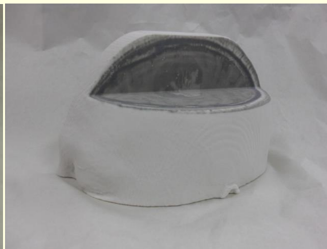
左図 粉末造形方式に よる出力例
