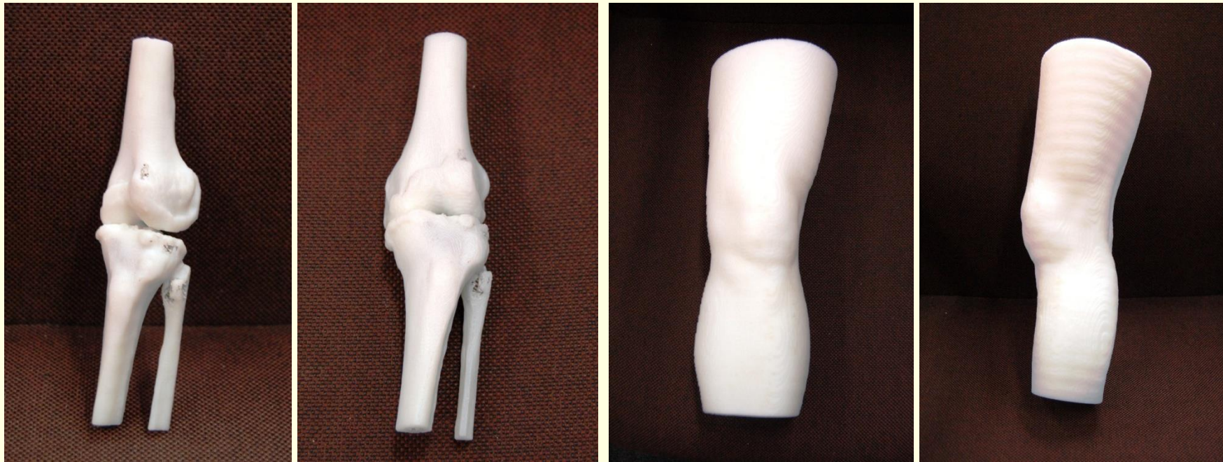
上図 熱溶解積層方式による出力例 - ABS樹脂による造形例
